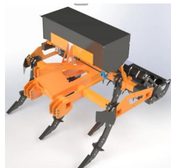
Глубоко-рыхлитель Навесной Виноградниковый РНВ-2,5 с внесением удобрений.
